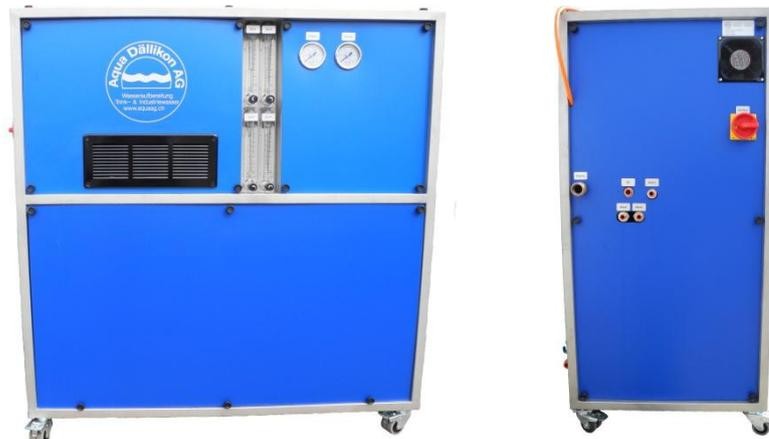
**Aufbereitung der ersten Stufe** liefert 400 Liter pro Stunde Umkehrosmosewasser mit einem Leitwert von  $< 10 \mu\text{S/cm}$ . Von dem integrierten Stapelbehälter mit einem Fassungsvermögen von 50 Litern kann das UO – Wasser bei Bedarf via der anlagenintegrierten UO – Druckerhöhungsanlage\* zu den entsprechenden Verbrauchern gefördert werden.
