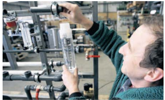
Markus Brennwald montiert Teile einer Strassenabwasserreinigungsanlage
